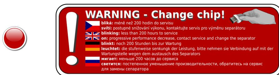
Во время работы системы ATMOScare об этом сигнализирует красный индикатор, находящийся на передней панели (компрессоры без системы управления) или непосредственно на панели системы управления компрессора. При активации системы (включении установки) индикатор мигает от одного до трех раз (в зависимости от типа компрессора).
